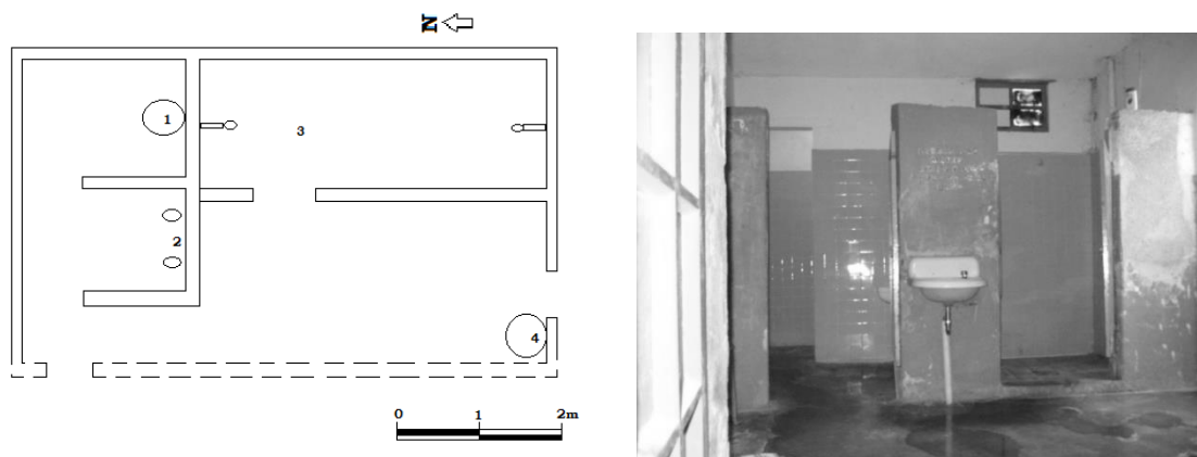
Fig. VII.47 a-b Fig. 47 a imagen que muestra el área del baño en el cual se usó una nomenclatura para identificar la distribución de los elementos que lo conforman; 1.- área de la tasa sanitaria, 2.- área de mingitorios, 3.- área de regaderas y 4.- calentador de agua o boiler, Fig. 47 b imagen en la que se observan los elementos del baño. Dibujó y fotografió Eduardo López Cruz (07/12/2007).
